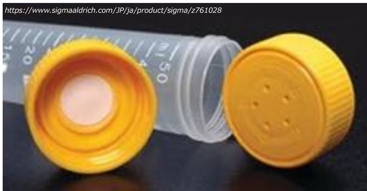
特殊フィルターで飛散防止. 培養後, 通気穴からホルマリン等を注入
